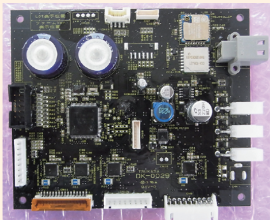
●太陽光追尾用制御基板
